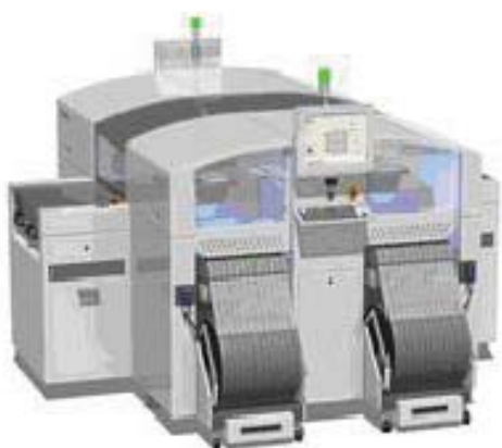
Рис. 2. Автомат—установщик компонентов по технологии SMT
