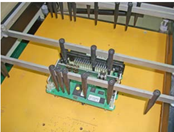
Рис. 10. Пример прижима тестируемого изделия к иглам адаптера
