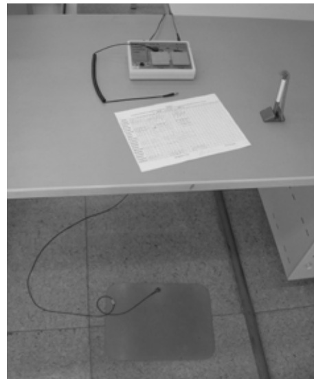
Рис. 4. Рабочее место контроля статического электричества обуви и браслетов на базе устройства PGT-100
