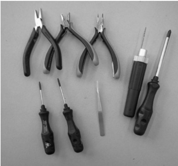
Рис. 3. Антистатический инструмент, применяемый при монтаже электронных модулей
