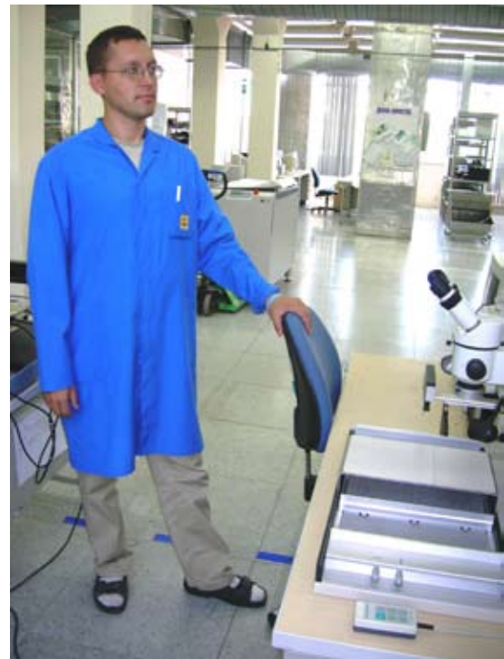
Рис. 2. Антистатические халат, обувь и мебель на производстве электронных модулей
