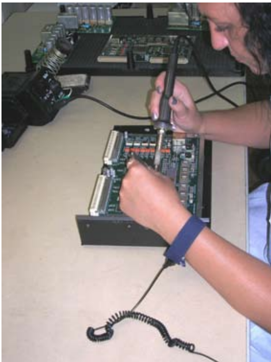
Рис. 1. Рабочее место монтажника, оснащенное антистатическими столом и браслетом
