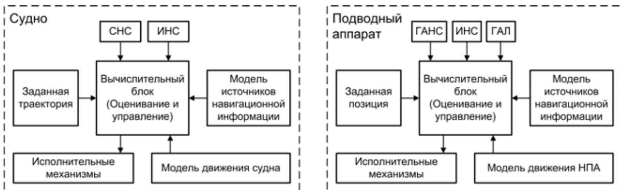
Рис. 1. Схема типовой СУ движением комплекса по заданной траектории
