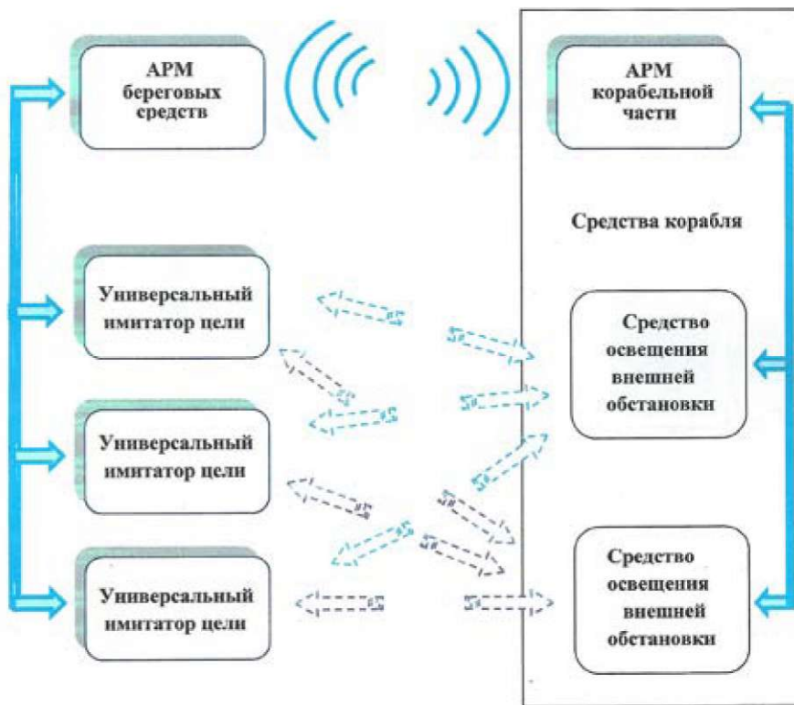
Рис. 1. Взаимодействие мобильной береговой системы обслуживания и диагностики с корабельными средствами освещения обстановки
