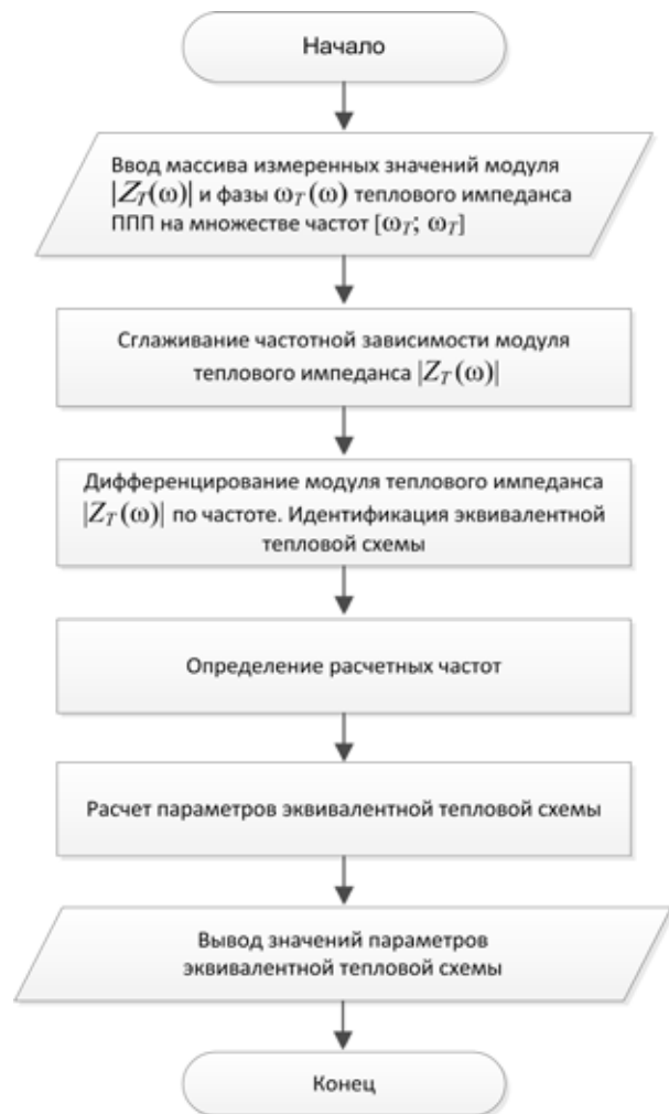
Рис. 3. Блок-схема алгоритма идентификации параметров эквивалентных тепловых схем ППП по частотным тепловым характеристикам
