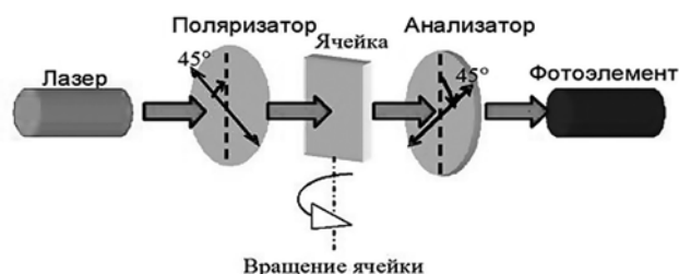
Рис. 1. Схема установки с вращением ячейки по оси, параллельной лучу лазера
