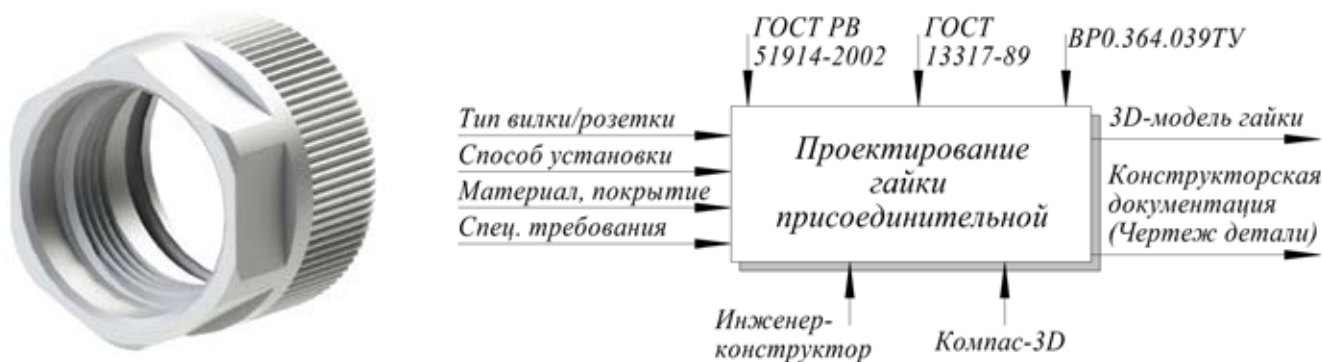
Рис. 4. 3D-модель гайки присоединительной и IDEF0-модель процесса ее проектирования
