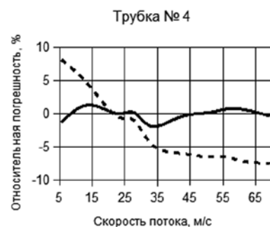
Рис. 8. Зависимость относительной погрешности от скорости потока для исследуемых ПСД
