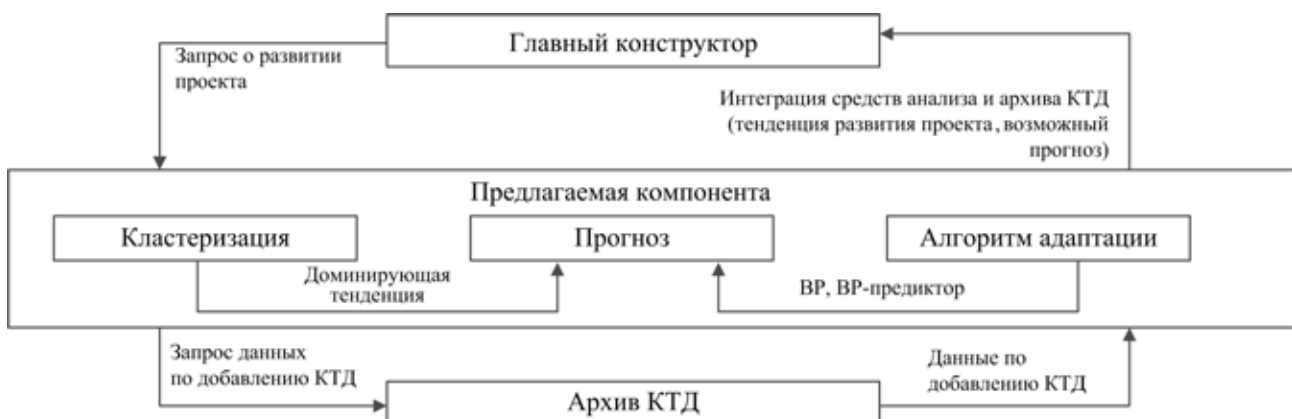
Рис. 2. Архитектура СКВ с компонентой анализа метрик (КТД – конструкторско-техническая документация)
