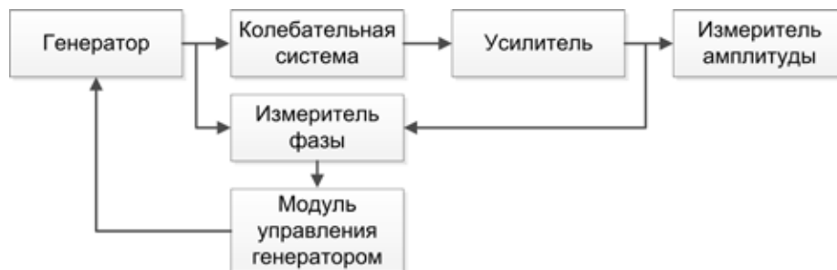
Рис. 2. Функциональная схема, поясняющая работу аппаратно-программного комплекса в режиме вынужденных колебаний с поддержанием заданного значения разности фазы путем подстройки частоты
