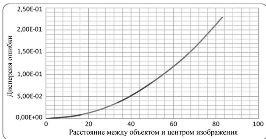
Рис. 5. Зависимость ошибки оценивания при удалении объекта от центра изображения
