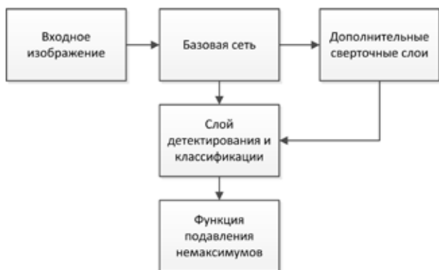
Рис. 1. Обобщенная архитектура модели SSD
