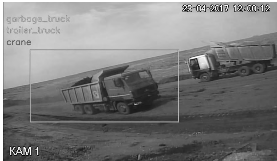
Рис. 3. Пример детектирования грузовика с выводом отладочной информации. В реальной системе прямоугольник и ключевые слова не отображаются в кадре, более того, кадры сжимаются специальным образом, чтобы снизить объем передаваемой информации
