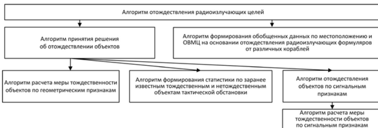
Рис. 1. Архитектура алгоритма отождествления радиоизлучающих объектов
