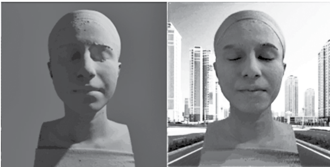
Рис. 7. Пример измененного освещения на карте, полученного путем рендеринга, – слева; пример фотографии, полученной смешиванием карты освещения и исходной фотографии через нейронную сеть ( Y ), – справа
