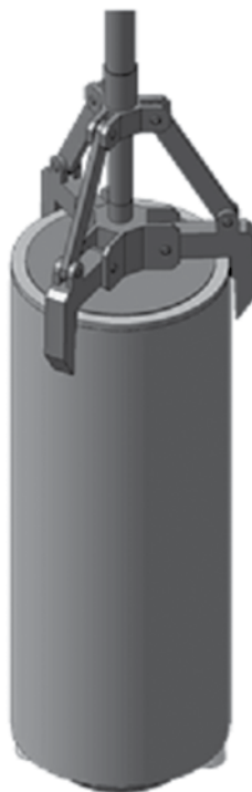
Рис. 1. Механизм захвата манипулятора
