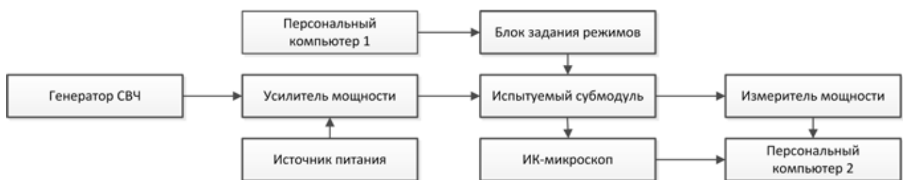
Рис. 3. Структурная схема стенда для исследования характеристик submodule ВУМ
