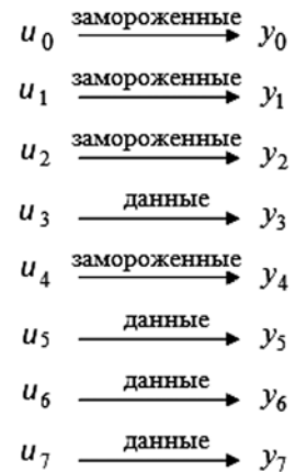
Рис. 2. Принцип фиксации зашумленных каналов
