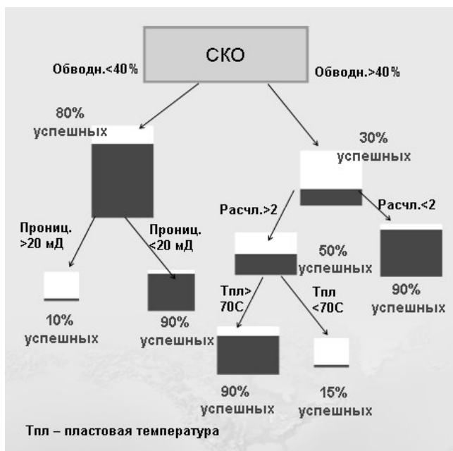
Рис. 3. Дерево принятия решений для СКО (успех: прирост добычи более 5 т/сут)
